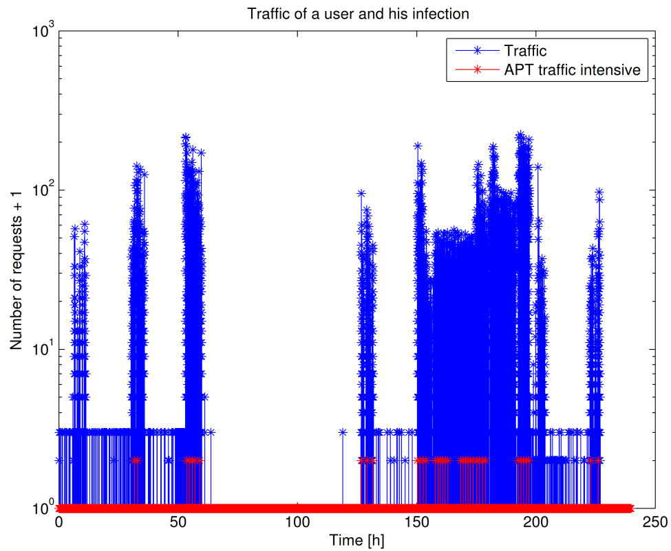
Figuur 2.15: Netwerkverkeer van de geïnfecteerde gebruiker met een agressieve gegevensstroom gebaseerde APT (Resolutie : 1s) [1].
